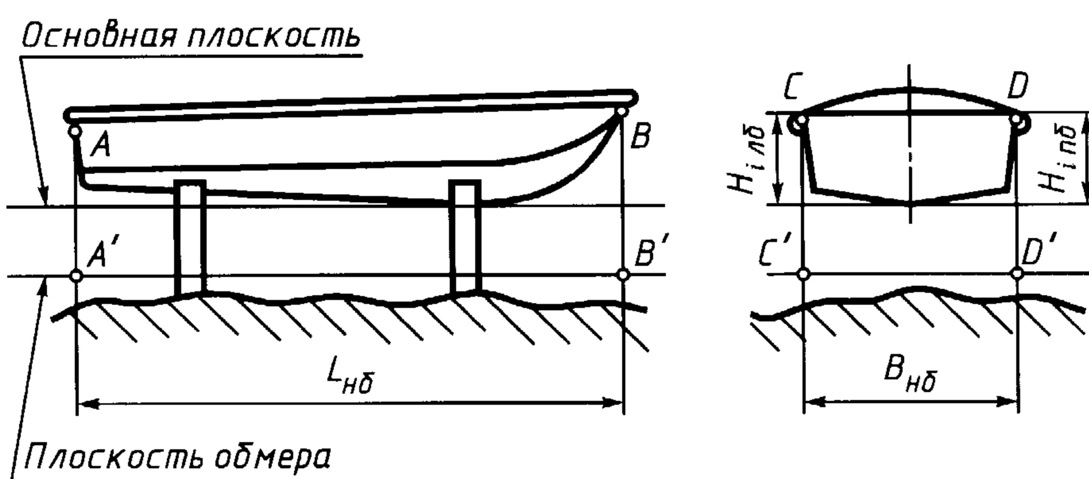
*A, B, C и D — пример характерных точек по длине и ширине корпуса; A', B', C' и D' — проекции точек A, B, C и D на плоскость отсчета; L<sub>нб</sub>, B<sub>нб</sub> — измеряемые размеры по длине и ширине корпуса; C, D — пример характерных точек по высоте корпуса; H<sub>i\_лб</sub>, H<sub>i\_пб</sub> — измеряемые размеры по высоте корпуса по левому и правому бортам*
